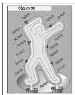
Εικόνα 5: Απομάκρυνση του κεριού με θέρμανση και ψήσιμο του κεραμικού
